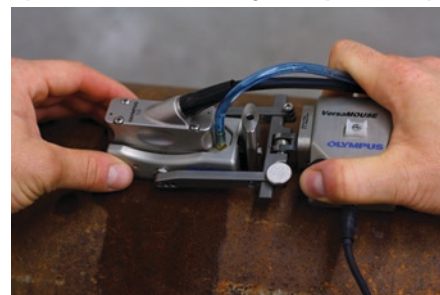
Сканер VersaMOUSE и RexoFORM – Коррозионный мониторинг
