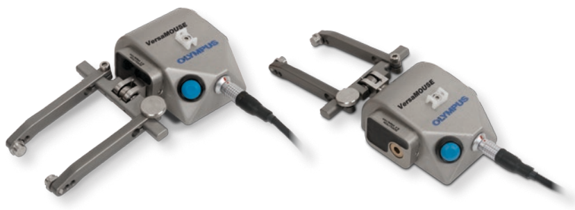
Подпружиненная вилка легко крепится и устанавливается под углом 90°.
